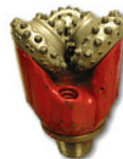
Cabezal del barrenador utilizado para perforar la tierra
