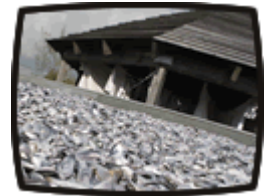
Utilizan las conchas de los mejillones para el aislamiento de las casas!
